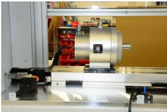
L'asse lineare può essere posizionato in maniera esatta con un pacchetto a cavo singolo AKD e AKM (inclusa unità di controllo). A questo si aggiunge un motore in kit KBM, responsabile del sincronismo dei tubi alimentati
